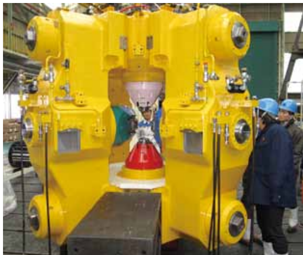
J-PARC中性子ビームライン設置の高圧装置「圧姫」 (八木健彦氏提供)
