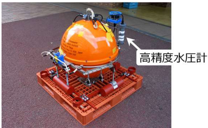
図4 水圧計搭載海底地震計 (東京大学 HP)
