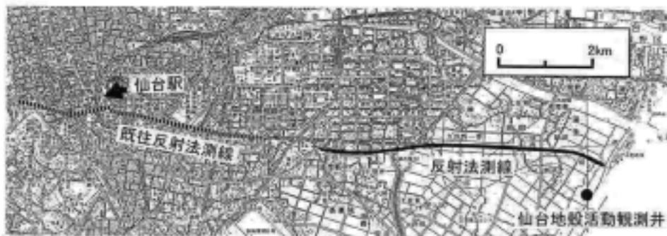
Fig. 1 観測井と反射法測線位置
