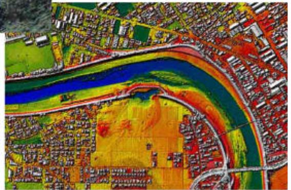
防破堤箇所の洗堀・堆積事例（段彩図表示）
