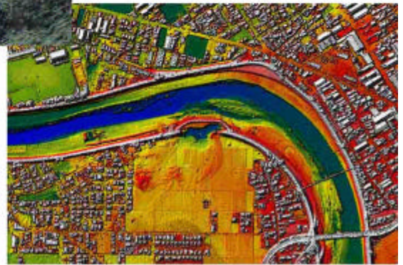
防破堤箇所の洗堀・堆積事例（段彩図表示）
