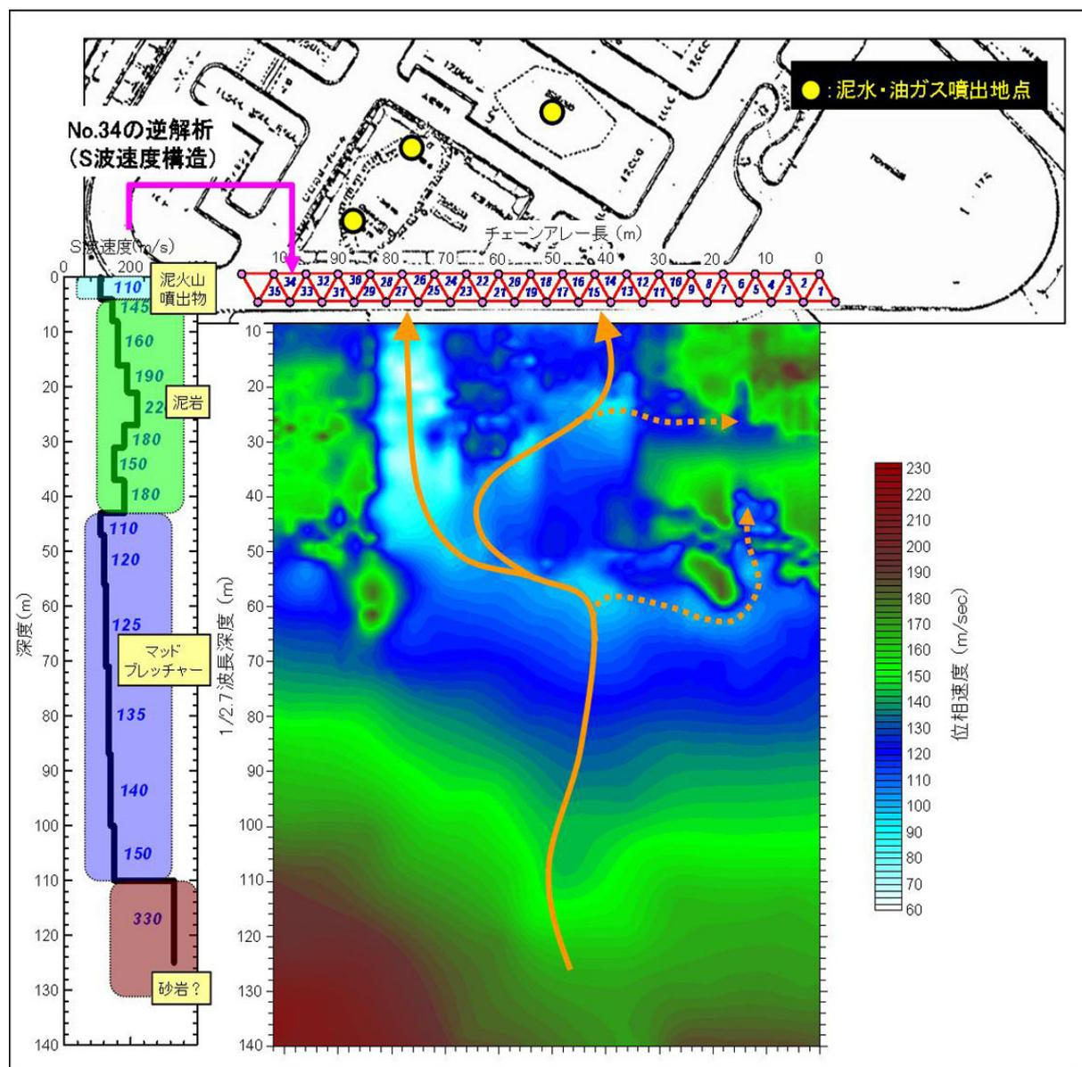
積成盆地の深部では圧密-非排水条件で異常高圧帯を形成していることが多い。異常高圧のシールが破れ、何らかの経路で地表に漏出すると泥火山としてガスや泥水を噴出し、また周辺地層を軟弱化させる。このような泥火山の地下構造は不明であり、深部探査によく用いられる反射法地震探査でも反射面が発達しないために構造探査が困難である。
