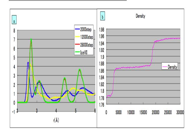
東京工業大学の河村雄行先生の作成したMXDORTOというプログラム(平尾一之・河村雄行著、パソコンによる材料設計、裳華房、1994、P. 230)を用いて、高圧条件下での水の分子シミュレーション計算を行った。MXDORTOは分子動力学法を用いた分子シミュレーションを行うプログラムである。分子動力学法とは、系を構成する原子・分子(粒子)間の相互作用モデルから求めた個々の粒子の運動方程式を解いて粒子を運動させ、新たな粒子の配置を生み出していき、そこから系の安定構造や物性、さらに動的性質(振動スペクトル、粘性率など)を求める手法である。この分子動力学法の計算結果は、粒子間の相互作用モデルに依存して大きく左右される。本研究では河村(2005、低温科学、64、3-10)の相互作用モデルを用いて計算を行いた。このモデルは水の物性(密度、自己拡散係数や振動スペクトルなど)を定量的に再現している(河村、2005、低温科学、64、3-10)。氷灯は室温で約1GPaまで加圧することでえられる氷であるが、氷灯を室温のままさらに加圧すると、約2GPaで相転移を起こし氷畑へと構造を変える。
