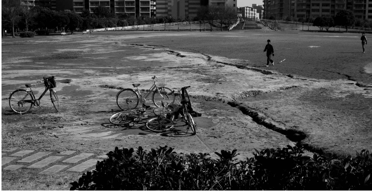
写真：液状化ゾーンにおける断層（延長約120m、落差約20cm、開口性） 縦断面は右方向が上り、断層が前面の人の前に斜めに走る。その左下方向 に噴砂が起きた。（葛巻海浜公園：千葉市美浜区ひび野1丁目）
