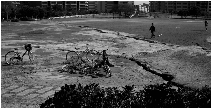
写真：液状化ゾーンにおける断層（延長約120m、落差約20cm、開口性） 縦断面は右方向が上り、断層が前面の人の前に斜めに走る。その左下方方向 に噴砂が起きた。（葛巻海浜公園：千葉市美浜区ひび野1丁目）
