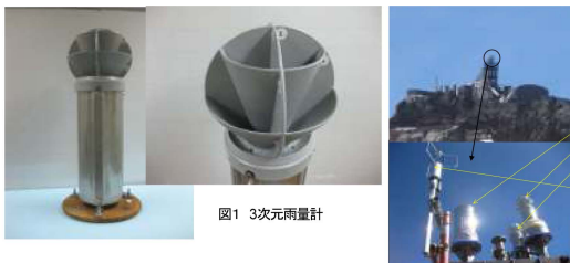
転倒マス雨量計 3次元雨量計 3D転倒マス雨量計 超音波3次元風向風速計 図2 富士山頂での設置状況
