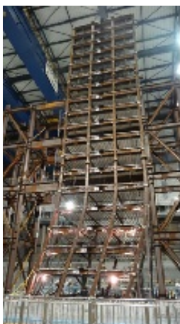
鉄骨造試験体 の最終崩壊形
