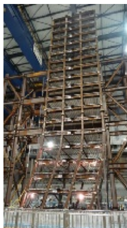
鉄骨造試験体 の最終崩壊形
