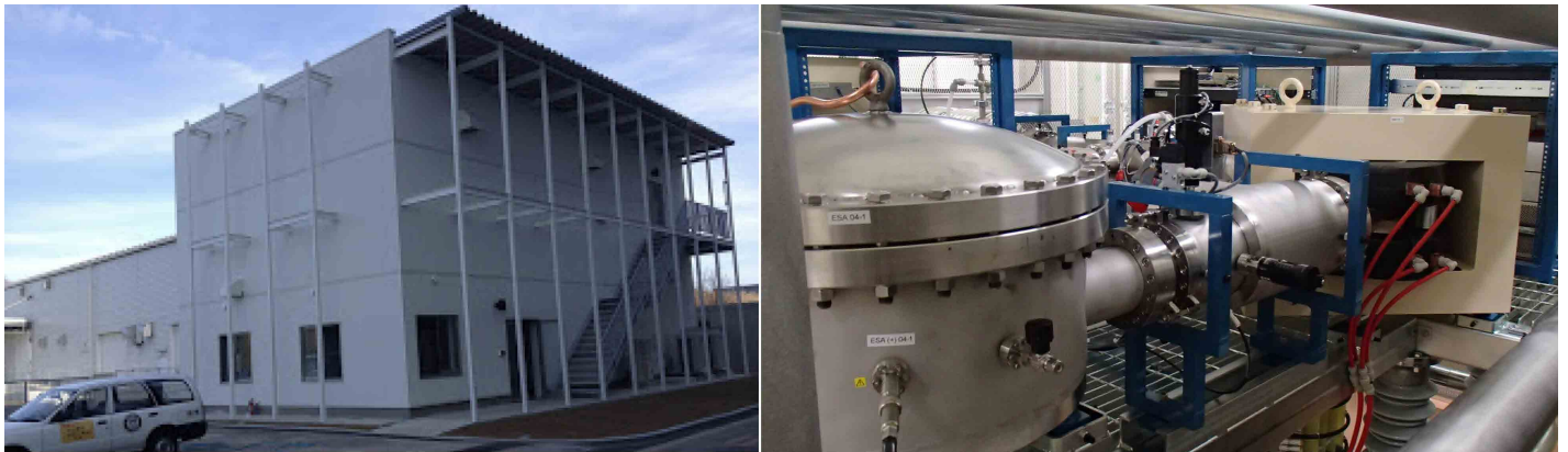
東大柏キャンパスに新設の加速器実験棟(左)とシングルステージ加速器質量分析装置の検出器部分(右)
