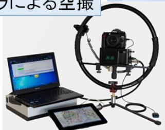
写真撮影と同時に写真中心位置を自動計測可能
