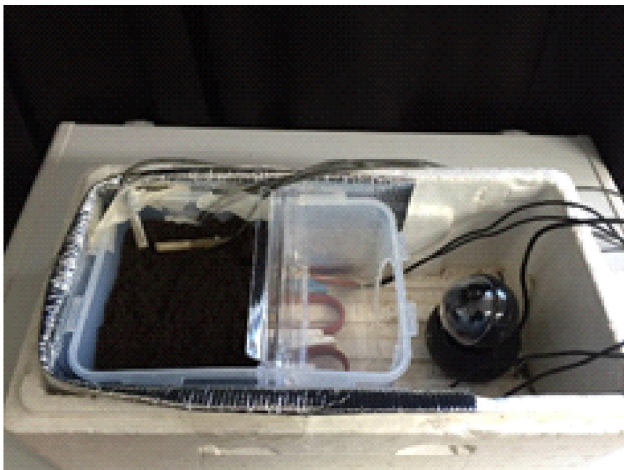
霜柱の発生実験・観察装置
