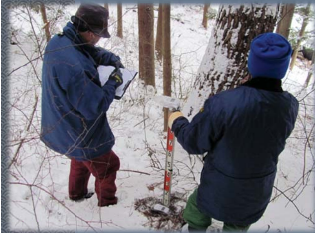
地表および 1.0 m 高での放射線量測定
