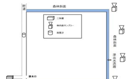
図 本宮市サイト (降雨取水) における機器設置概観
