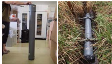
図 浮遊砂サンプラー (右図は側溝への設置例)
