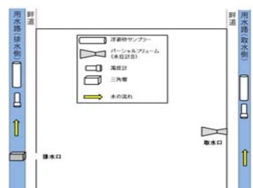
図 本宮市サイト (用水路取水) における機器設置概観
