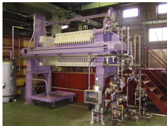
脱水・洗浄用フィルタプレス
